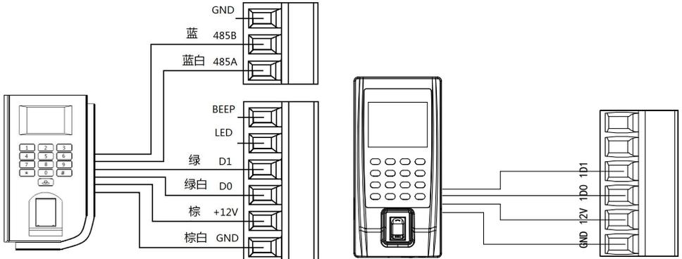
图 4: 指纹仪的实物接线图
