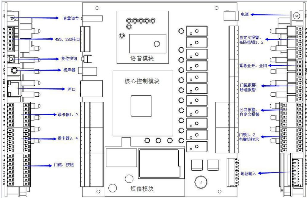
图 1：DW-6834DN 控制板结构图
