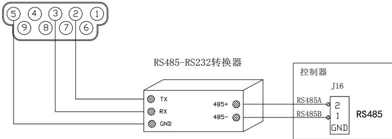
图 8: RS485 通讯方式连接图
