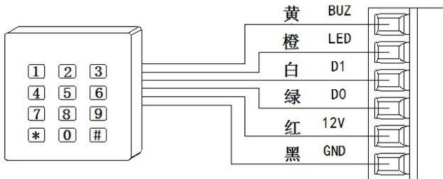
图 2：读卡器的实物接线图
